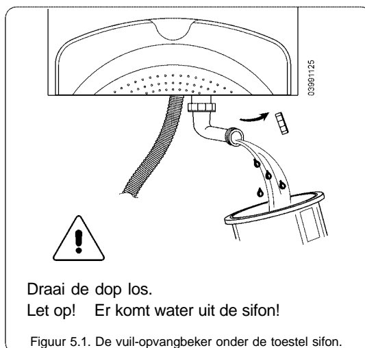
Figuur 5.1. De vuil-opvangbeker onder de toestel sifon.
