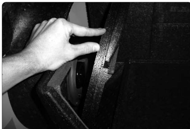
Figuur 14.5 Verwijder de instroomkeel.
